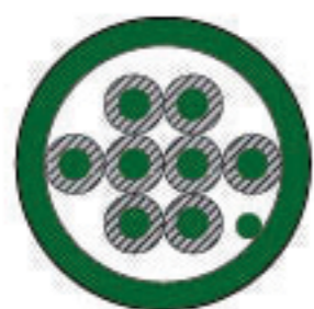
4 pairs x 24 AWG UTP Category 5e Cable
